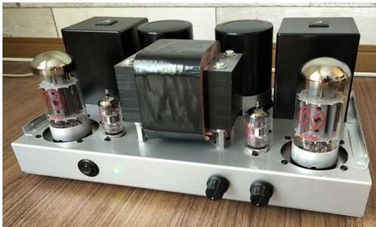
本機は、多極出力管を使ったアンプながら低い出力インピーダンスとなるよう設計し、ダンピングの良い音を狙いました。ポイントは、スクリーングリッド電圧を下げてバイアスを浅くし、カソード帰還の効きを最大限にすることです。また、スクリーングリッド電圧をカソードに対して定電圧化することで、音の輪郭が際立ってシャープな音質が得られる効果があります。
